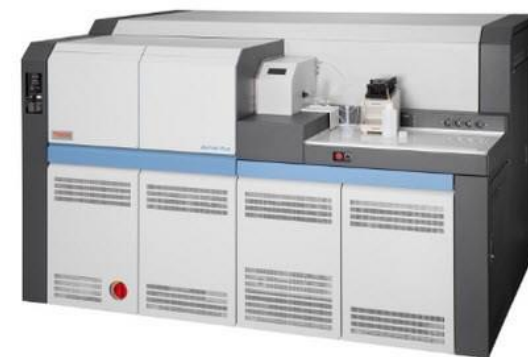
Neptune HR-ICP-MS sektorový magnetický s dvojí fokusací + multicollector
