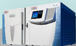
TSQ 9000 (pumpa 300L/s), zdroj EI
