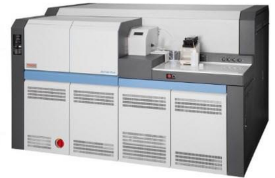
Neptune HR-ICP-MS sektorový magnetický s dvojí fokusací + multicollector
